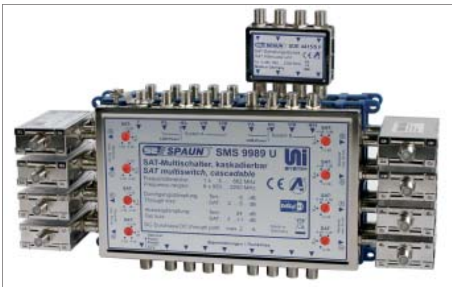
Einfach durch Aufstecken – Dämpfungssteller für eine optimale Anpassung der Empfangssignale und Multischalterrelais beim Empfang von acht Sat-ZF-Ebenen mithilfe von 2 x SMS 9989 U.
